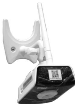
VEGG MONTERT, PEKER NEDOVER
